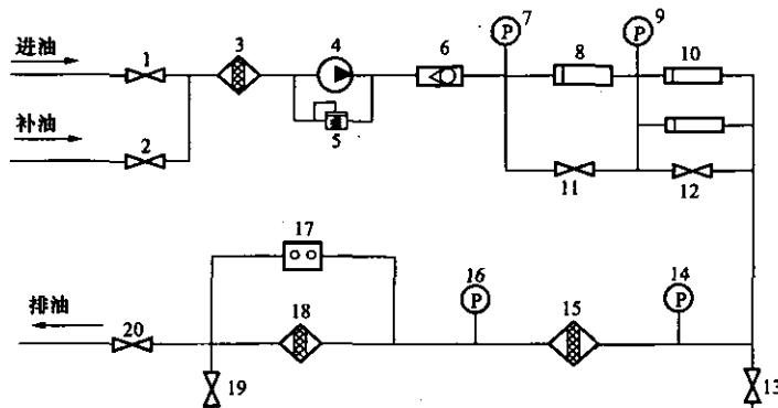
1—进油阀；2—补油阀；3—吸油滤油器；4—油泵；5—溢流阀；6—单向阀；7—系统压力表；8—脱水器；
